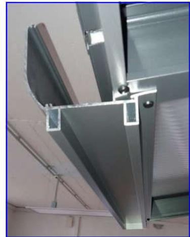
Festlegen, auf welcher Seite später das Regenwasser abgeleitet werden soll. An entsprechender Stelle in das Regenrinnenprofil ein 40mm Ø Loch bohren. In dieses das Schraubstutzen-Set einsetzen und mit den beigelegten Rohrbögen und dem Rohr eine Verbindung zum Pfosten und dann weiter nach unten an die gewünschte Stelle verlegen.
